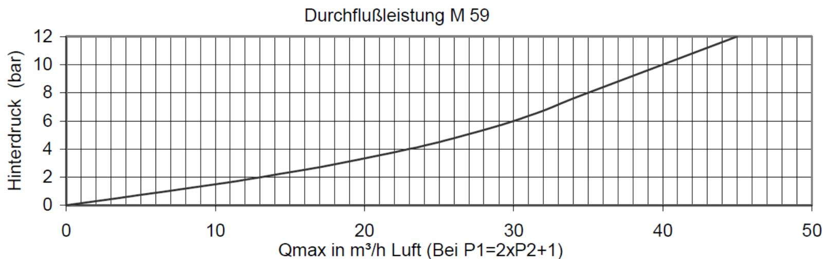
Der Flaschendruckminderer M 59 reduziert den Flaschendruck von verdichteten und unter Druck gelösten Gasen, sowie von Flüssiggasen von max. 300 bar auf einen max. Druck von 16 bar.
