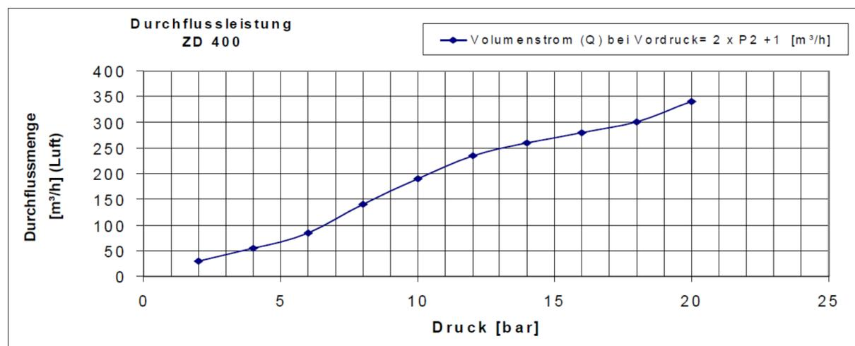
Der Druckminderer ZD 400 reduziert den max. Vordruck von 300 bar auf einen Hinterdruck von max. 20 bar.
