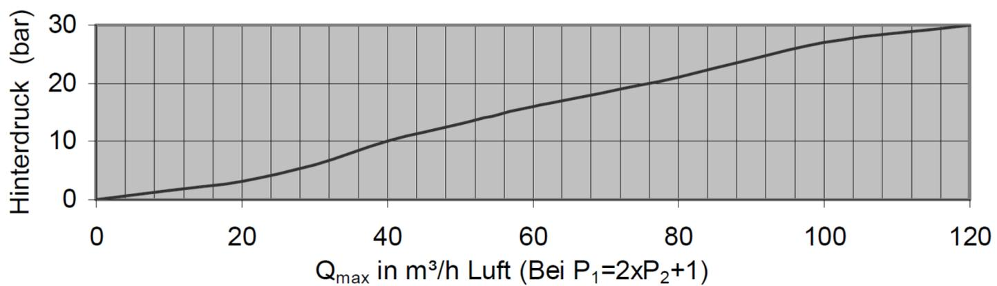
Mit dem Zentraldruckminderer ZD 60 wird der Eingangsdruck von max. 300 bar auf einen Druck von max. 30 bar reduziert und konstant gehalten.
